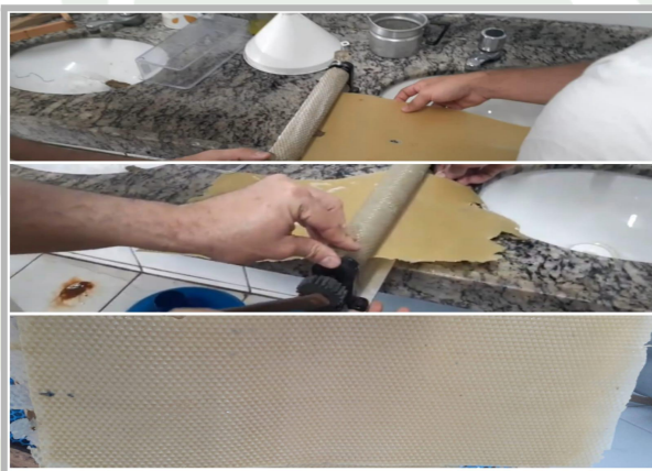
Figura 02: Utilização do cilindro alveolador no processo de beneficiamento de cera alveolada.
