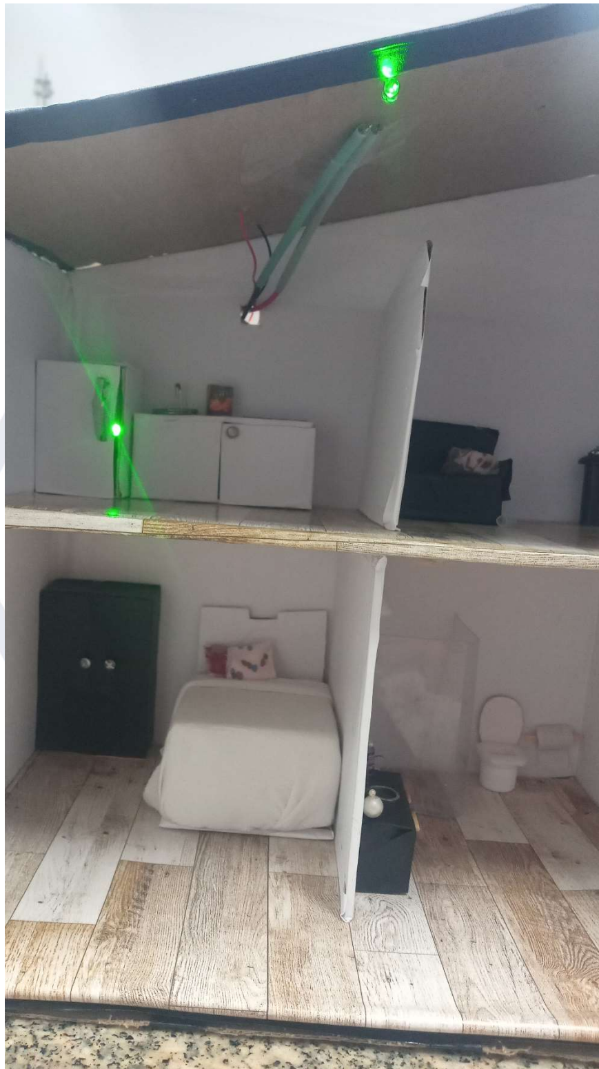
Figura 07: Montagem da primeira maquete que possui telhado no formato “duas águas” com a placa 01 e dois leds instalados em cômodos diferentes
