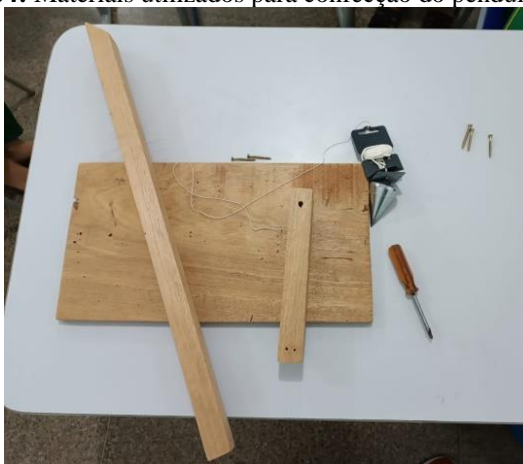
Figura 04: Materiais utilizados para confecção do pêndulo simples
