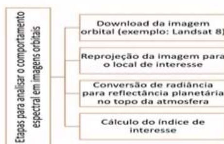
Figura 02: Esquema das etapas para calcular o NDVI
