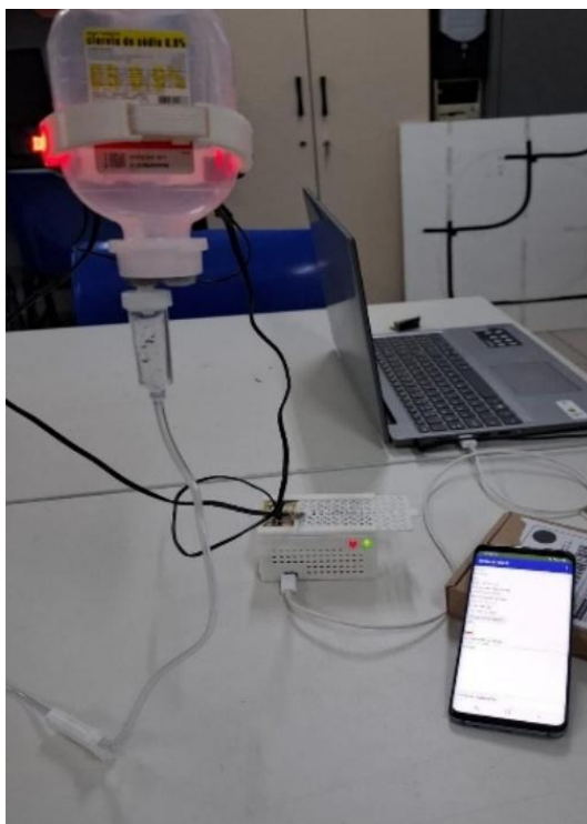
Figura 2 – Sistema completo em simulação com bolsa de dieta enteral, app e ESP32.
