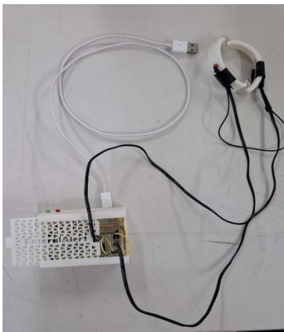
Figura 1 – Protótipo montado com ESP32, LEDs e sensor LDR em suporte impresso.
