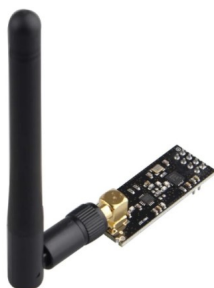
Figura 08: Transceptor nRF24L01 com antena para alcance de 1 km
