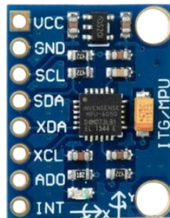
Figura 05: MPU-6050 – Comunicação I2C
